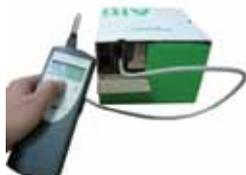
通过多功能下载器及电缆来配置包装内的变频器
